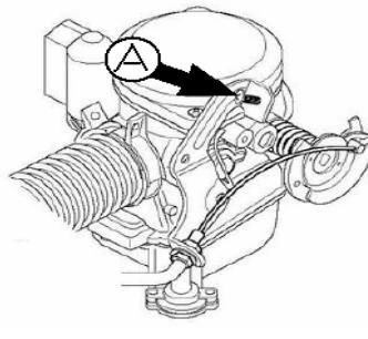
На заведенным двигателем вращайте винт, указанный на рисунке стрелкой и буквой «А», вращение по часовой стрелке - увеличение, против часовой – уменьшение числа оборотов колен. вала. Обороты холостого хода должны соответствовать 1700 об./мин. $\pm$ 100. Данную операцию владелец может выполнять самостоятельно по необходимости, и в процессе обкатки двигателя.
