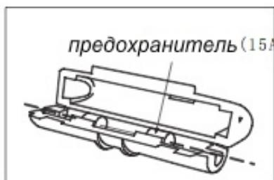
**Внимание!** Всегда заменяйте сгоревший предохранитель предохранителем, рассчитанным на тот же ток. Никогда не используйте заменители, например фольгу или проволоку. Если установленный запасной предохранитель также перегорел, это означает, что имеется неисправность в электрооборудовании. В этом случае обратитесь в уполномоченный гарантийный сервис см. пункт 13.
