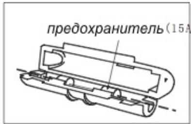
**Внимание!** Всегда заменяйте сгоревший предохранитель предохранителем, рассчитанным на тот же ток. Никогда не используйте заменители, например фольгу или проволоку. Если установленный запасной предохранитель также перегорел, это означает, что имеется неисправность в электрооборудовании. В этом случае обратитесь в уполномоченный гарантийный сервис **см. пункт 13.**
