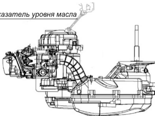
На рисунке обозначен масляный щуп - с его помощью проверяется уровень масла.
