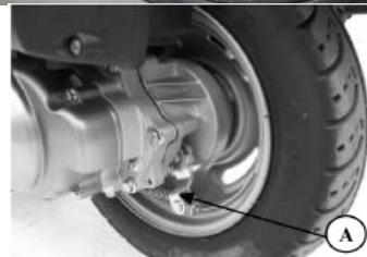
Измерьте расстояние, пройденное концом рычага, от положения без нагрузки. Оно должно быть в пределах 10 – 20 мм. Заднее колесо должны быть заблокировано. При расхождении отрегулируйте гайкой «А» (вращая по часовой стрелке - уменьшаете, против часовой - увеличиваете) на рисунке. Проверьте наличие смазки на тормозных тросах, при отсутствии и смажьте.
