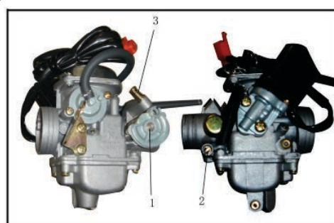
На заведенным двигателем вращайте винт «3», вращение по часовой стрелке - увеличение, против часовой – уменьшение числа оборотов колен. вала. Обороты холостого хода должны соответствовать 1500 об./мин. $\pm$ 100.
